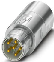
M23, Connettore per giunti, serie: M23 PRO, diritto, schermati: sì, Per il bloccaggio rapido standard e ONECLICK, Numero di poli: 5+PE, Senso di rotazione: standard, tipo di connessione del contatto: Spina, Connessione a crimpare, diametro cavi: 9,5 mm ... 14,5 mm, codifica: N, L'articolo è senza piombo secondo la direttiva RoHS II senza eccezione 6c (Pb < 0,1 %)
