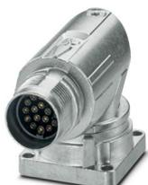
M17, Connettore per apparecchi anteriore, serie: M17 PRO, angolato, orientabile, schermati: sì, Per il bloccaggio rapido standard e ONECLICK, Numero di poli: 17, Senso di rotazione: standard, tipo di connessione del contatto: Femmina, Connessione a crimpare, misura flangia: 28 mm x 28 mm, codifica: N, L'articolo è senza piombo secondo la direttiva RoHS II senza eccezione 6c (Pb < 0,1 %)
