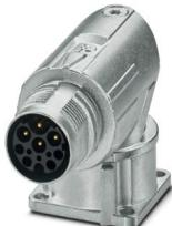
M17, Connettore per apparecchi anteriore, serie: M17 PRO, angolato, orientabile, schermati: sì, Per il bloccaggio rapido standard e ONECLICK, Numero di poli: 5+3+PE, Senso di rotazione: standard, tipo di connessione del contatto: Spina, Connessione a crimpate, misura flangia: 26 mm x 26 mm, codifica: N, L'articolo è senza piombo secondo la direttiva RoHS II senza eccezione 6c (Pb < 0,1 %)
