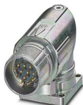
M23, Connettore per apparecchi anteriore, serie: M23 PRO, angolato, orientabile, schermati: sì, Per il bloccaggio rapido standard e ONECLICK, Numero di poli: 12, Senso di rotazione: standard, tipo di connessione del contatto: Spina, Connessione a crimpare, misura flangia: 28 mm x 28 mm, codifica: N, L'articolo è senza piombo secondo la direttiva RoHS II senza eccezione 6c (Pb < 0,1 %)
