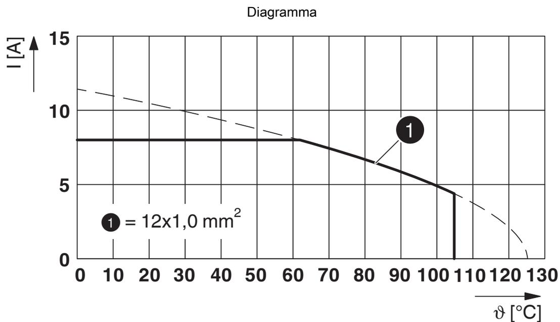
$I$  = intensità di corrente,  $\vartheta$  = temperatura ambiente, 12x 8 A
