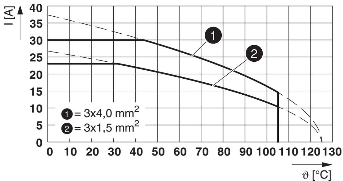
$I$  = intensità di corrente,  $\vartheta$  = temperatura ambiente, 3 x 30 A (curva 1), 3 x 24 A (curva 2)
