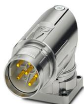
M23, Connettore per apparecchi anteriore, serie: M23 PRO, angolato, orientabile, schermati: sì, Per il bloccaggio rapido standard e ONECLICK, Numero di poli: 5+PE, Senso di rotazione: standard, tipo di connessione del contatto: Spina, Connessione a crimpare, misura flangia: 26 mm x 26 mm, codifica: N, L'articolo è senza piombo secondo la direttiva RoHS II senza eccezione 6c (Pb < 0,1 %)
