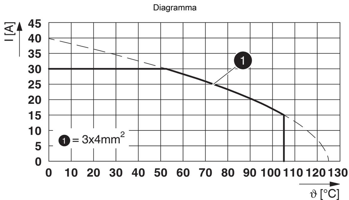
$I$  = intensità di corrente,  $\vartheta$  = temperatura ambiente, 3 x 30 A + 2 x 1 A costante
