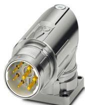
M23, Connettore per apparecchi anteriore, serie: M23 PRO, angolato, orientabile, schermati: sì, Per il bloccaggio rapido standard e ONECLICK, Numero di poli: 4+3+PE, Senso di rotazione: standard, tipo di connessione del contatto: Spina, Connessione a crimpare, misura flangia: 26 mm x 26 mm, codifica: N, L'articolo è senza piombo secondo la direttiva RoHS II senza eccezione 6c (Pb < 0,1 %)
