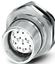
M23, Connnettore per apparecchi posteriore, serie: CA, diritto, schermati: sì, per bloccaggio standard e SPEEDCON, Numero di poli: 16+3, Senso di rotazione: standard, tipo di connessione del contatto: Femmina, Connessione a saldare, Guarnizione assiale, Fissaggio centrale, codifica: N, Prodotto alternativo secondo RoHS II senza eccezione 6c (Pb < 0,1 %) cod. art.: 1245542
