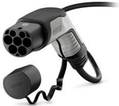
CHARX connect comfort, Tipo 2, Cavo di ricarica AC, 20 A permanente, 250 V AC, con connettore di ricarica lato infrastruttura ed estremità aperta, cavi: 4 m, nero, a spirale, con cappuccio di protezione, custodia: nero, grigio, Logo PHOENIX CONTACT, IEC 62196-2, per la ricarica con corrente alternata (AC) di veicoli elettrici (EV)
