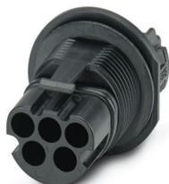
Connettore per apparecchi posteriore, Serie di prodotti: PRC 35, colore: nero, numero poli: 5, tensione di dimensionamento: 690 V AC, corrente nominale: 35 A, Tipo di connessione: Connessione a crimpare, Tipo di connessione del contatto: Spina, Il dado va ordinato separatamente
