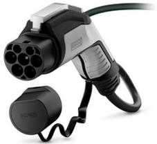
CHARX connect comfort, GB/T, Cavo di ricarica AC, 32 A permanente, 440 V AC, con connettore di ricarica lato veicolo ed estremità aperta, cavi: 5 m, nero, diritto, con cappuccio di protezione, custodia: nero, grigio, Logo PHOENIX CONTACT, GB/T 20234.2-2015, GB/T 18487.1-2015, per la ricarica con corrente alternata (AC) di veicoli elettrici (EV) con prese GB/T lato veicolo
