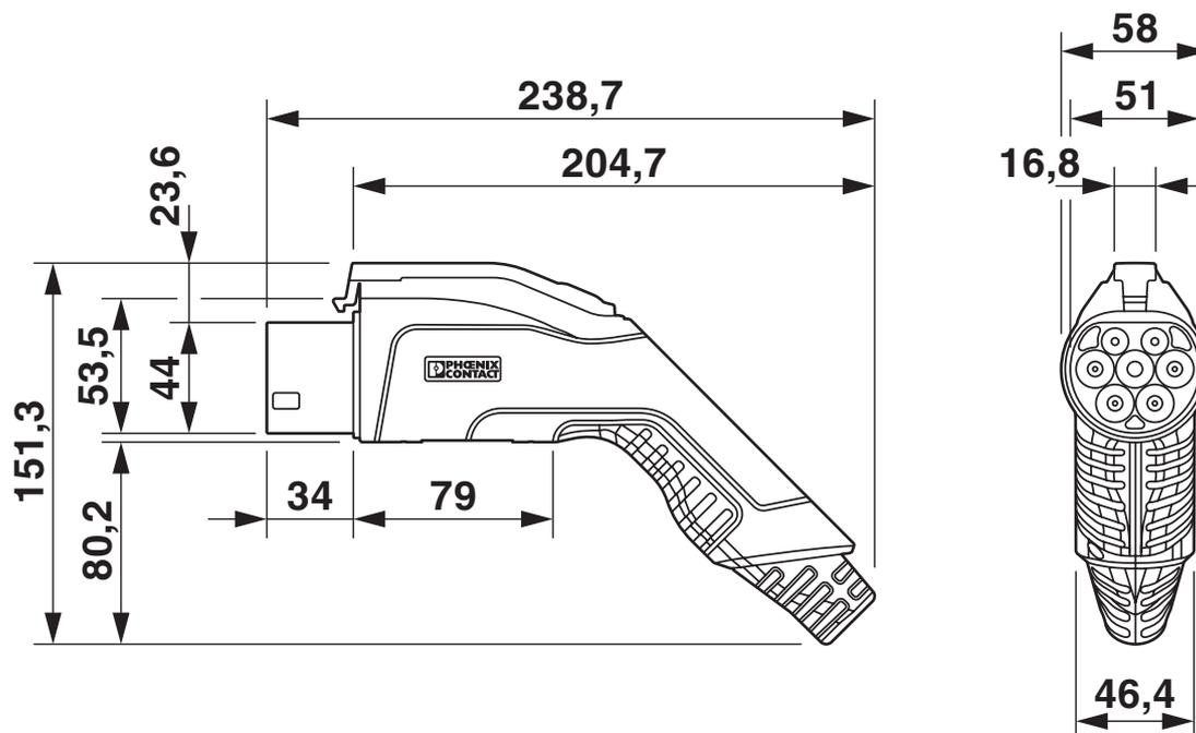
Assicurarsi che il connettore di ricarica lato veicolo sia inserito in un apposito supporto per il connettore di ricarica che garantisca una protezione di almeno IP24 secondo IEC 61851-1 durante l'intera pausa di ricarica. Per realizzare tale supporto, utilizzare le dimensioni del connettore di ricarica lato veicolo. Per informazioni più dettagliate sulle misure consultare l'area download.
