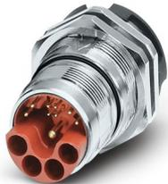
M23, Connettore per apparecchi posteriore, serie: SH, diritto, schermati: sì, per bloccaggio standard e SPEEDCON, Numero di poli: 8+4+PE, tipo di connessione del contatto: Spina, Connessione a crimpare, Fissaggio centrale M26 x 1, Spessore della parete min.: 1,5 mm, Spessore della parete max.: 5 mm
