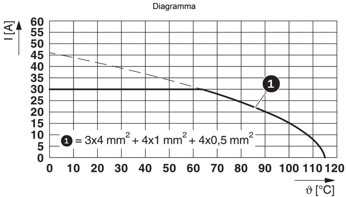
$I$  = intensità di corrente,  $\vartheta$  = temperatura ambiente, contatti di potenza A-C: 3 x fino a 30 A, contatti di segnalazione: 4 x 2 A costante, contatti dati: 4 x 1 A costante
