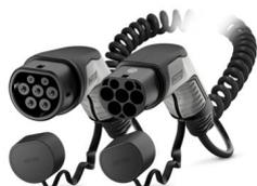
CHARX connect comfort, Tipo 2, Cavo di ricarica AC mobile, 32 A permanente, 480 V AC, con connettori di ricarica lato veicolo e connettori di ricarica lato infrastruttura, cavi: 4 m, nero, a spirale, con cappuccio di protezione, custodia: nero, grigio, Logo PHOENIX CONTACT, IEC 62196-2, per la ricarica con corrente alternata (AC) di veicoli elettrici (EV) con prese lato veicolo tipo 2
