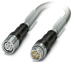
Connettori rivestiti in materiale plastico mediante stampaggio su entrambi i lati, serie: KSF, M23-Femmina, sovrastampato in materia plastica dritto, numero poli: 4+PE, tipo di bloccaggio: Bloccaggio a vite, su M23-Spina, sovrastampato in materia plastica dritto, numero poli: 4+PE, lunghezza cavo: 5 m, schermata: no, colore guaina esterna: grigio RAL 7001
