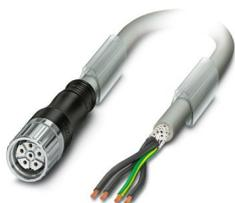
Conduttori per cavi rivestiti in materiale plastico mediante stampaggio, serie: KSF, M23-Femmina, sovrastampato in materia plastica dritto, numero poli: 4+PE, tipo di bloccaggio: Bloccaggio a vite, lunghezza cavo: 5 m, schermata: no, colore guaina esterna: grigio RAL 7001
