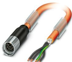
Conduttori per cavi rivestiti in materiale plastico mediante stampaggio, serie: KST, M17-Femmina, sovrastampato in materia plastica dritto, numero poli: 7+PE, tipo di bloccaggio: Bloccaggio a vite, lunghezza cavo: 2 m, schermata: sì, colore guaina esterna: arancio RAL 2003, Prodotto alternativo secondo RoHS II senza eccezione 6c (Pb < 0,1 %) cod. art.: 1245260
