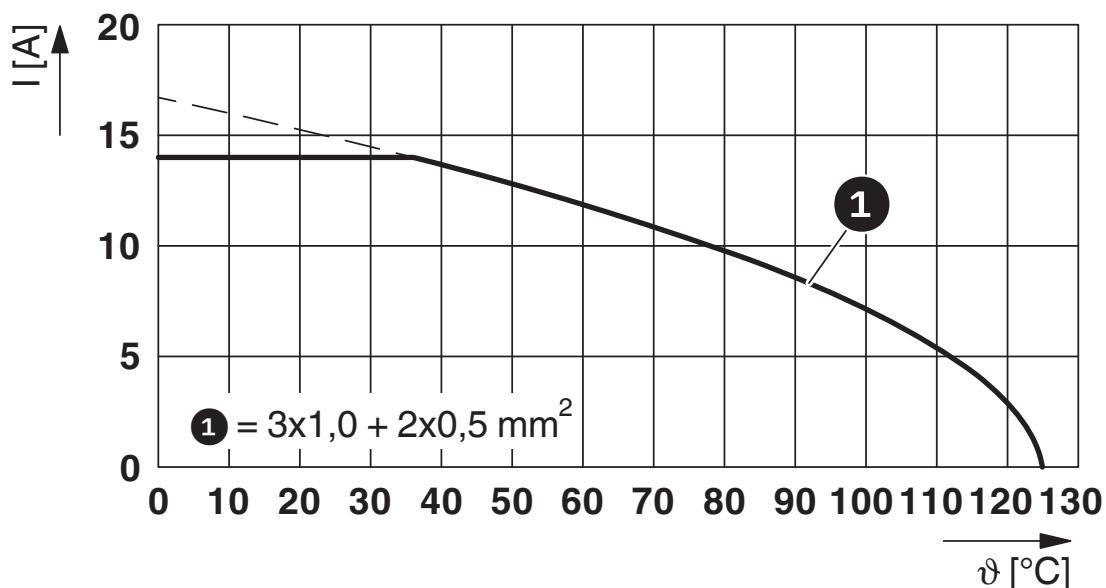
$I$  = intensità di corrente,  $\vartheta$  = temperatura ambiente,  $3 \times 14 \text{ A} + 2 \times 2 \text{ A}$  costante
