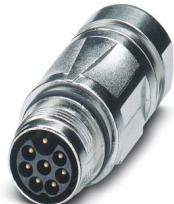
Connettore per giunti, diritto, per bloccaggio standard e SPEEDCON, M17, numero poli: 7+PE, tipo di connessione del contatto: Spina, schermata: sì, grado di protezione: IP67, diametro cavi: 10 mm ... 12,5 mm, numero poli: 8, tipo di connessione: Connessione a crimpare, serie: ST, Questo articolo è in continuo adattamento. Alternativa senza piombo secondo RoHS II senza eccezione 6c (Pb < 0,1%) possibile in anticipo su richiesta.
