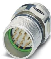
M23, Connettore per apparecchi anteriore, serie: CA, diritto, schermati: sì, per bloccaggio standard e SPEEDCON, Numero di poli: 16, Senso di rotazione: standard, tipo di connessione del contatto: Spina, Attacco a saldare, Guarnizione assiale, Fissaggio centrale M20 x 1,5, posizionabile mediante dado di sicurezza, codifica: N
