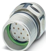
M23, Connettore per apparecchi anteriore, serie: CA, diritto, schermati: sì, per bloccaggio standard e SPEEDCON, Numero di poli: 12, Senso di rotazione: standard, tipo di connessione del contatto: Femmina, Connessione a crimpare, Guarnizione assiale, Fissaggio centrale M20 x 1,5, posizionabile mediante dado di sicurezza, codifica: N
