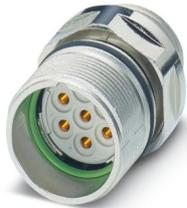
M23, Connettore per apparecchi anteriore, serie: CA, diritto, schermati: sì, per bloccaggio standard e SPEEDCON, Numero di poli: 8+1, Senso di rotazione: standard, tipo di connessione del contatto: Femmina, Connessione a crimpare, Guarnizione assiale, Fissaggio centrale M20 x 1,5, posizionabile mediante dado di sicurezza, codifica: N
