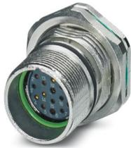
M23, Connettore per apparecchi posteriore, serie: CA, diritto, schermati: sì, per bloccaggio standard e SPEEDCON, Numero di poli: 16+2+FE, Senso di rotazione: standard, tipo di connessione del contatto: Femmina, Connessione a crimpare, Guarnizione assiale, Fissaggio centrale, codifica: N, Prodotto alternativo secondo RoHS II senza eccezione 6c (Pb < 0,1 %) cod. art.: 1245050
