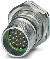
M23, Connettore per apparecchi posteriore, serie: CA, diritto, schermati: sì, per bloccaggio standard e SPEEDCON, Numero di poli: 16+2+FE, Senso di rotazione: standard, tipo di connessione del contatto: Spina, Connessione a crimpare, Guarnizione assiale, Fissaggio centrale, codifica: N, Prodotto alternativo secondo RoHS II senza eccezione 6c (Pb < 0,1 %) cod. art.: 1245049
