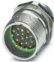
M23, Connettore per apparecchi anteriore, serie: CA, diritto, schermati: sì, per bloccaggio standard e SPEEDCON, Numero di poli: 16+2+FE, Senso di rotazione: standard, tipo di connessione del contatto: Spina, Connessione a crimpare, Guarnizione assiale, Fissaggio centrale M20 x 1,5, codifica: N
