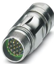
M23, Connnettore per giunti, serie: CA, diritto, schermati: sì, per bloccaggio standard e SPEEDCON, Numero di poli: 16+2+FE, Senso di rotazione: standard, tipo di connessione del contatto: Spina, Connessione a crimpere, diametro cavi: 3 mm ... 14,5 mm, codifica: N, Questo articolo è in continuo adattamento. Alternativa senza piombo secondo RoHS II senza eccezione 6c (Pb < 0,1%) possibile in anticipo su richiesta.
