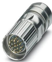
M23, Connettore per cavi, serie: CA, diritto, schermati: sì, Bloccaggio a vite, Numero di poli: 16+2+FE, Senso di rotazione: standard, tipo di connessione del contatto: Spina, Connessione a crimpare, diametro cavi: 6 mm ... 10 mm, codifica: N, Prodotto alternativo secondo RoHS II senza eccezione 6c (Pb < 0,1 %) cod. art.: 1245003
