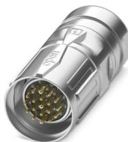
M23, Connnettore per cavi, serie: CA, diritto, schermati: sì, SPEEDCON, Numero di poli: 16+2+FE, Senso di rotazione: standard, tipo di connessione del contatto: Spina, Connessione a crimpere, diametro cavi: 10 mm ... 14,5 mm, codifica: N, Prodotto alternativo secondo RoHS II senza eccezione 6c (Pb < 0,1 %) cod. art.: 1244993
