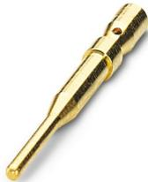
Contatto a crimpare, Spina, tornito, diametro contatti: 1 mm, intervallo di crimpatura: 0,5 mm<sup>2</sup> ... 1 mm<sup>2</sup>, Prodotto alternativo secondo RoHS II senza eccezione 6c (Pb < 0,1 %) cod. art.: 1244972
