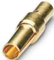
Contatto a crimpare, Femmina, tornito, diametro contatti: 1 mm, intervallo di crimpatura: 0,14 mm<sup>2</sup> ... 0,56 mm<sup>2</sup>, Prodotto alternativo secondo RoHS II senza eccezione 6c (Pb < 0,1 %) cod. art.: 1244902
