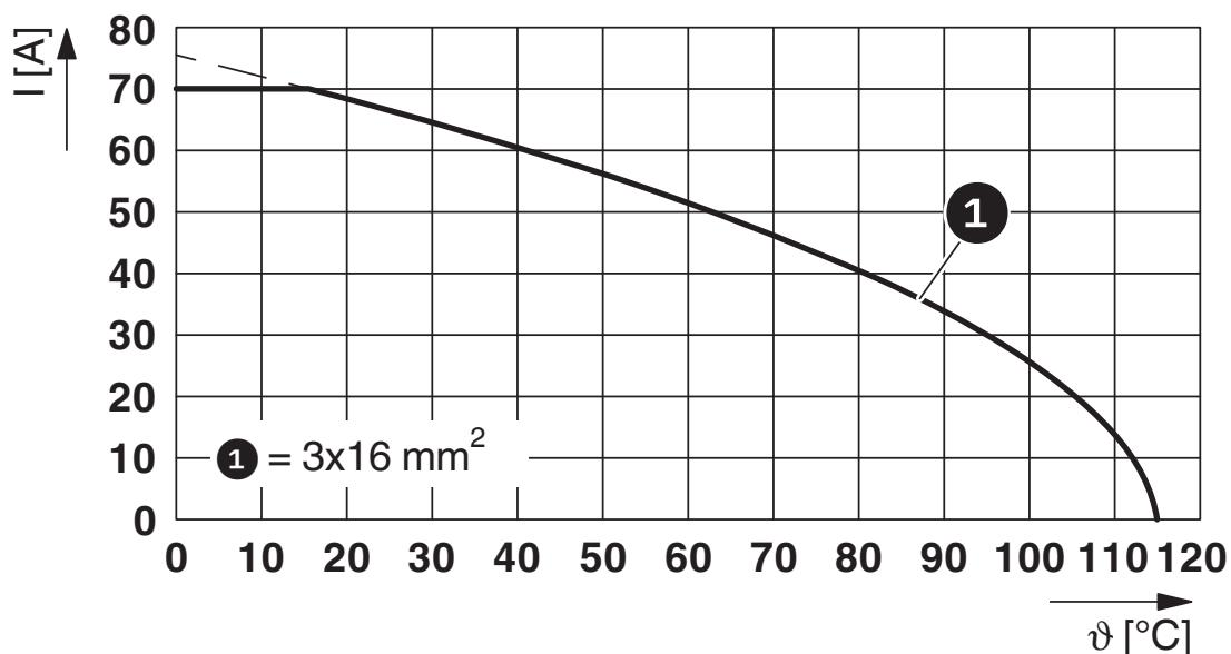
$I$  = intensità di corrente,  $\vartheta$  = temperatura ambiente, contatti di potenza A-C: 3x fino a 70 A, contatti di segnalazione: 4x 2 A costante, contatti dati: scarichi
