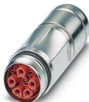
M40, Connnettore per giunti, serie: SB, diritto, lungo, schermati: sì, per bloccaggio standard e SPEEDCON, Numero di poli: 4+4+4+PE / 3+N+PE, tipo di connessione del contatto: Femmina, Connessione a crimpere, diametro cavi: 14 mm ... 20,5 mm, codifica: CAT5, codifica 1, Questo articolo è in continuo adattamento. Alternativa senza piombo secondo RoHS II senza eccezione 6c (Pb < 0,1%) possibile in anticipo su richiesta.
