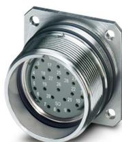
Connettore per apparecchi posteriore, diritto, Bloccaggio a vite, M27, numero poli: 26, tipo di connessione del contatto: Femmina, O-ring radiale, 4xM3, schermata: sì, numero poli: 26, tipo di connessione: Connessione a crimpare, serie: HC
