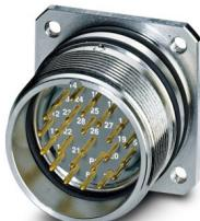
Connettore per apparecchi posteriore, diritto, Bloccaggio a vite, M27, numero poli: 26, tipo di connessione del contatto: Spina, O-ring radiale, 4xM3, schermata: sì, numero poli: 26, tipo di connessione: Connessione a crimpare, serie: HC
