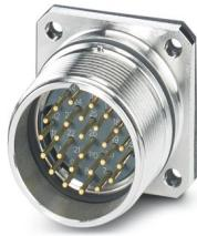
Connettore per apparecchi anteriore, diritto, Bloccaggio a vite, M27, numero poli: 26, tipo di connessione del contatto: Spina, Guarnizione piatta, 4x Ø 3,2, schermata: sì, numero poli: 26, tipo di connessione: Connessione a crimpare, serie: HC, Questo articolo è in continuo adattamento. Alternativa senza piombo secondo RoHS II senza eccezione 6c (Pb < 0,1%) possibile in anticipo su richiesta.
