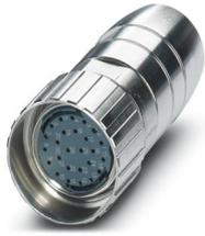
Connettore per cavi, diritto, Bloccaggio a vite, M27, numero poli: 26, tipo di connessione del contatto: Femmina, schermata: sì, grado di protezione: IP67, diametro cavi: 2 mm ... 14,5 mm, numero poli: 26, tipo di connessione: Connessione a crimpare, serie: HC, Questo articolo è in continuo adattamento. Alternativa senza piombo secondo RoHS II senza eccezione 6c (Pb < 0,1%) possibile in anticipo su richiesta.
