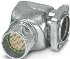
M23, Connnettore per apparecchi anteriore, serie: CA, angolato, orientabile, schermati: sì, per bloccaggio standard e SPEEDCON, Numero di poli: 16+3, Senso di rotazione: standard, tipo di connessione del contatto: Spina, Attacco a saldare, O-ring assiale, 4x Ø 3,2, codifica: N, Questo articolo è in continuo adattamento. Alternativa senza piombo secondo RoHS II senza eccezione 6c (Pb < 0,1%) possibile in anticipo su richiesta.
