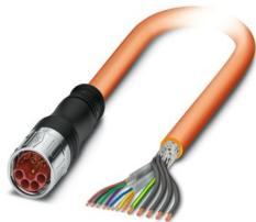
Conduttori per cavi rivestiti in materiale plastico mediante stampaggio, serie: KSH, M23-Spina, sovrastampato in materia plastica dritto, numero poli: 4+4+4+PE, tipo di bloccaggio: SPEEDCON, lunghezza cavo: 2 m, schermata: sì, colore guaina esterna: arancio RAL 2003, Questo articolo è in continuo adattamento. Alternativa senza piombo secondo RoHS II senza eccezione 6c (Pb < 0,1%) possibile in anticipo su richiesta.
