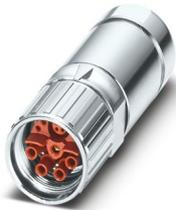
M23, Connettore per cavi, serie: SH, diritto, lungo, schermati: sì, Bloccaggio a vite, Numero di poli: 8+4+PE, tipo di connessione del contatto: Femmina, Connessione a crimpare, diametro cavi: 9 mm ... 12 mm, Questo articolo è in continuo adattamento. Alternativa senza piombo secondo RoHS II senza eccezione 6c (Pb < 0,1%) possibile in anticipo su richiesta.
