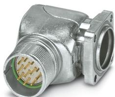
M23, Connettore per apparecchi anteriore, serie: CA, angolato, orientabile, schermati: sì, per bloccaggio standard e SPEEDCON, Numero di poli: 17, Senso di rotazione: standard, tipo di connessione del contatto: Spina, Connessione a crimpare, O-ring assiale, 4x Ø 3,2, codifica: N
