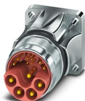
M23, Connettore per apparecchi anteriore, serie: SH, diritto, schermati: sì, per bloccaggio standard e SPEEDCON, Numero di poli: 8+4+PE, tipo di connessione del contatto: Spina, Connessione a crimpare, O-ring assiale, 4x Ø 3,2, misura flangia: 26 mm x 26 mm
