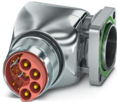
M23, Connettore per apparecchi anteriore, serie: SH, angolato, orientabile, schermati: sì, per bloccaggio standard e SPEEDCON, Numero di poli: 4+4+4+PE / 3+N+PE, tipo di connessione del contatto: Spina, Connessione a crimpare, O-ring assiale, 4x Ø 3,2, misura flangia: 26 mm x 26 mm
