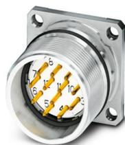
M23, Connettore per apparecchi anteriore, serie: CA, diritto, schermati: sì, per bloccaggio standard e SPEEDCON, Numero di poli: 12, Senso di rotazione: Invertito, tipo di connessione del contatto: Spina, Connessione a crimpare, Guarnizione piatta, 4x Ø 3,2, misura flangia: 25 mm x 25 mm, codifica: N
