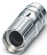
M23, Custodia per connettore circolare, serie: CA, diritto, schermati: sì, Bloccaggio a vite, diametro cavi: 3 mm ... 14,5 mm, Prodotto alternativo secondo RoHS II senza eccezione 6c (Pb < 0,1 %) cod. art.: 1244390
