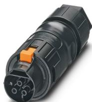
Spina di prova PRC, 2000 cicli di manovra, nera, scollegabile a mano, 3 poli, 1,5 mm<sup>2</sup> ... 6 mm<sup>2</sup> / 690 V / 35 A, con connessione a vite per cavi con diametro esterno 8 mm ... 21 mm.
