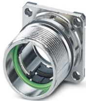
Connettore per apparecchi, montaggio anteriore senza inserto contatti, diritto, bloccaggio SPEEDCON, M23, guarnizione piatta, 4x Ø 3,2, schermato: sì, dimensioni flangia: 25 mm x 25 mm
