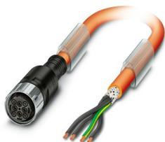
Conduttori per cavi rivestiti in materiale plastico mediante stampaggio, serie: KSM, M40-Femmina, sovrastampato in materia plastica dritto, numero poli: 4+3+PE, tipo di bloccaggio: Bloccaggio a vite, lunghezza cavo: 5 m, schermata: sì, colore guaina esterna: arancio RAL 2003
