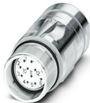
M23, Connnettore per giunti, serie: CA, diritto, schermati: sì, per bloccaggio standard e SPEEDCON, Numero di poli: 17, Senso di rotazione: standard, tipo di connessione del contatto: Femmina, Connessione a crimpire, diametro cavi: 3 mm ... 14,5 mm, codifica: N, Questo articolo è in continuo adattamento. Alternativa senza piombo secondo RoHS II senza eccezione 6c (Pb < 0,1%) possibile in anticipo su richiesta.
