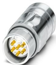
M23, Connettore per giunti, serie: CA, diritto, schermati: sì, per bloccaggio standard e SPEEDCON, Numero di poli: 6, Senso di rotazione: standard, tipo di connessione del contatto: Spina, Connessione a crimpire, diametro cavi: 4 mm ... 6 mm, codifica: N, Prodotto alternativo secondo RoHS II senza eccezione 6c (Pb < 0,1 %) cod. art.: 1244032
