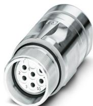
M23, Connnettore per giunti, serie: CA, diritto, schermati: sì, per bloccaggio standard e SPEEDCON, Numero di poli: 8+1, Senso di rotazione: standard, tipo di connessione del contatto: Femmina, Attacco a saldare, diametro cavi: 4 mm ... 6 mm, codifica: N, Prodotto alternativo secondo RoHS II senza eccezione 6c (Pb < 0,1 %) cod. art.: 1244027
