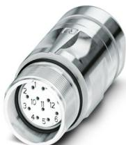
M23, Connnettore per giunti, serie: CA, diritto, schermati: sì, per bloccaggio standard e SPEEDCON, Numero di poli: 16+3, Senso di rotazione: standard, tipo di connessione del contatto: Femmina, Attacco a saldare, diametro cavi: 4 mm ... 6 mm, codifica: N, Prodotto alternativo secondo RoHS II senza eccezione 6c (Pb < 0,1 %) cod. art.: 1244011
