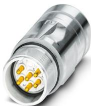
M23, Connnettore per giunti, serie: CA, diritto, schermati: sì, per bloccaggio standard e SPEEDCON, Numero di poli: 7, Senso di rotazione: standard, tipo di connessione del contatto: Spina, Attacco a saldare, diametro cavi: 6 mm ... 10 mm, codifica: N, Prodotto alternativo secondo RoHS II senza eccezione 6c (Pb < 0,1 %) cod. art.: 1244004
