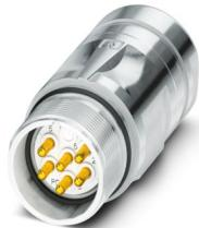
M23, Connnettore per giunti, serie: CA, diritto, schermati: sì, per bloccaggio standard e SPEEDCON, Numero di poli: 6, Senso di rotazione: standard, tipo di connessione del contatto: Spina, Attacco a saldare, diametro cavi: 10 mm ... 14,5 mm, codifica: N, Prodotto alternativo secondo RoHS II senza eccezione 6c (Pb < 0,1 %) cod. art.: 1243982
