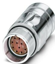
M23, Connettore per giunti, serie: CA, diritto, schermati: sì, per bloccaggio standard e SPEEDCON, Numero di poli: 12, Senso di rotazione: standard, tipo di connessione del contatto: Femmina, Connessione a crimpare, diametro cavi: 3 mm ... 14,5 mm, codifica: N, Questo articolo è in continuo adattamento. Alternativa senza piombo secondo RoHS II senza eccezione 6c (Pb < 0,1%) possibile in anticipo su richiesta.
